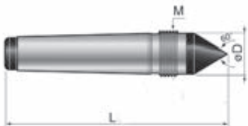
Hartmetallkopf mit Abdrückgewinde Full carbide tip with thread
